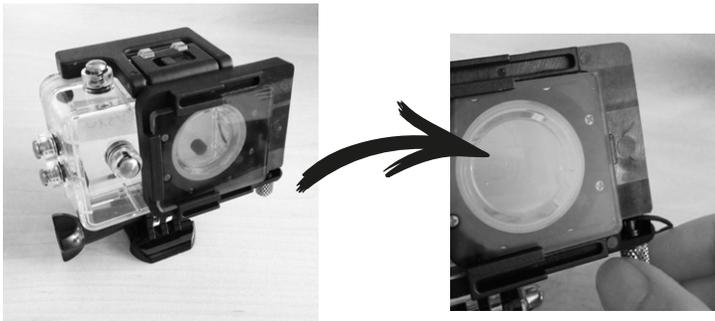
**Stecken Sie den Adapter auf das Gehäuse Ihrer Actioncam und ziehen Sie die Schraube fest.**
