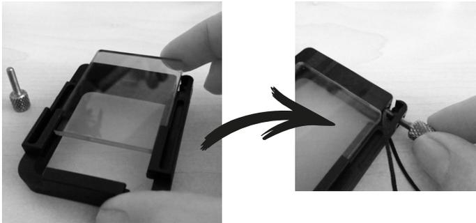
**Schieben Sie den Filter in den Adapter und platzieren Sie das Sicherheitsband. Dann drehen Sie die Schraube 1-2 Umdrehungen in das Gewinde.**
